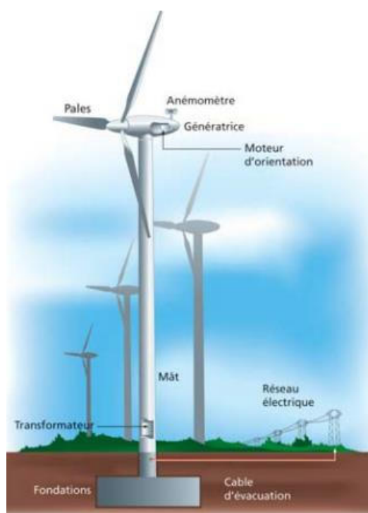
Figure 6 : Représentation schématique d'une éolienne (Source : EDF)
